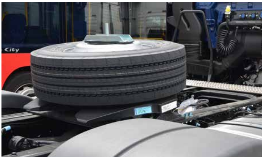
Opony w samochodzie ciężarowym mają bezpośrednie przełożenie na bezpieczeństwo. Gdy bieżnik ma mniej niż 1,6 mm grubości, należy je wymienić (fot. MJ)
